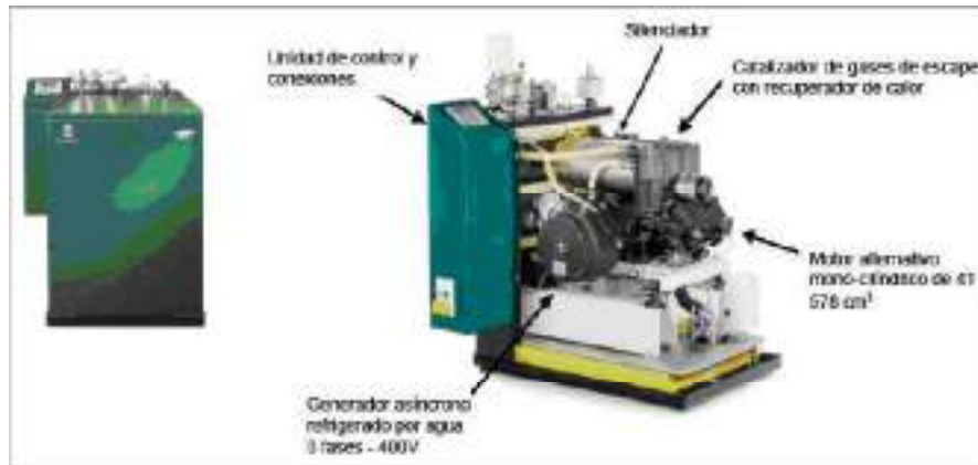
Figura 9.7. Motor de cogeneració de biogàs.
