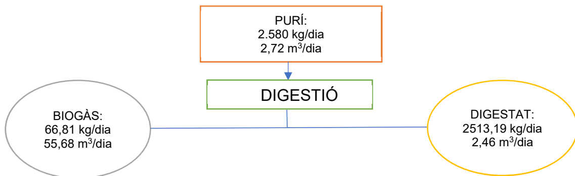
Figura 7.4. Esquema de les entrades i sortides de matèria de la digestió anaeròbia en sèrie.
